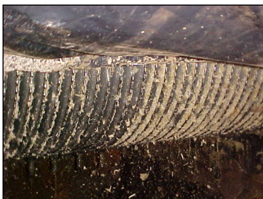
Figura 40 – Comparação de Parte do Rolo de Moenda Desgastado e Chapiscado Automaticamente. Fonte: OLIVEIRA, 2011.
