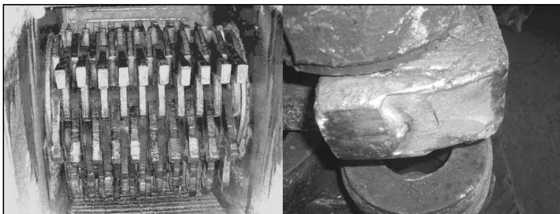
Figura 5 - Vista Interna do Desfibrador e Detalhe de Um Martelo Desgastado. Fonte: LIMA; FERRARESI, 2006.
