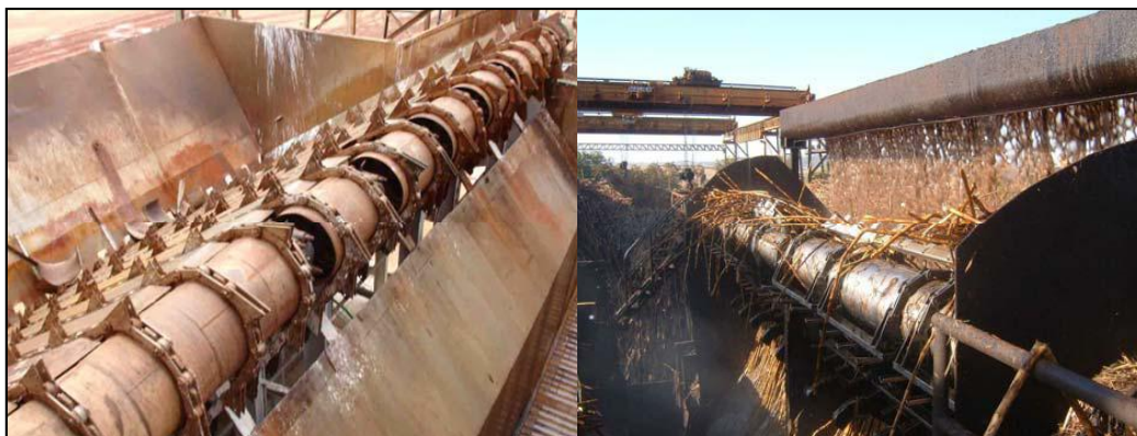
Figura 3 - Comparação da Mesa Alimentadora Durante a Parada e em Operação. Fonte: LIMA; FERRARESI, 2006.
