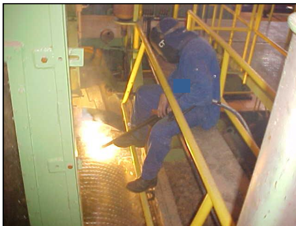
Figura 33 - Estrutura Inadequada Demonstrativo do Risco de Queda e Morte durante a Operação. Fonte: OLIVEIRA, 2010.
