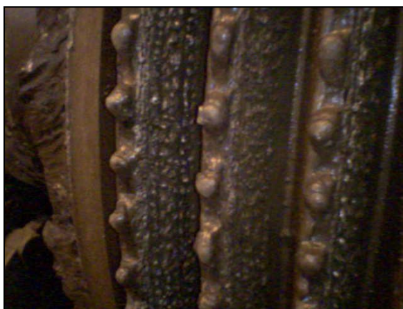
Figura 12 - Solda Manual de Chapisco com Camisa na Horizontal. Fonte: DOMINGUIE FILHO et al., 2008.
