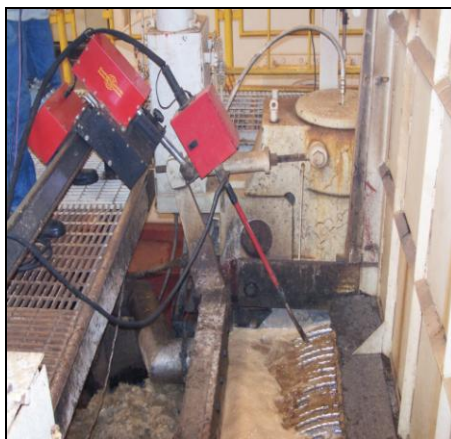
Figura 38 - Robô em Operação Durante a Safra, Aplicação Automatizada de Chapisco. Fonte: CASTOLIN EUTECTIC, 2009.
