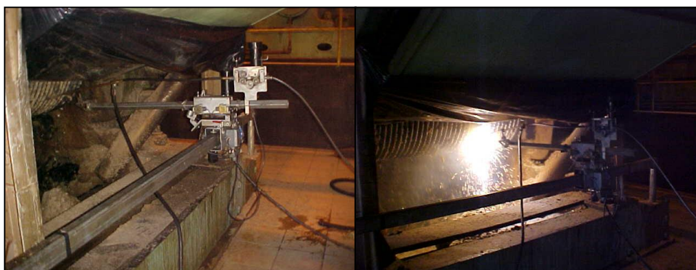
Figura 39 - Aplicação de Chapisco em Rolo de Moenda em Operação Posição de Saída. Fonte: OLIVEIRA, 2011.
